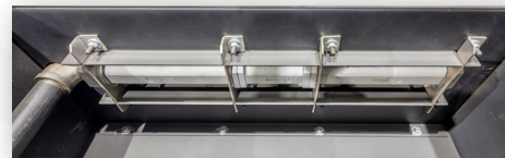
Quemador de Gas en línea
