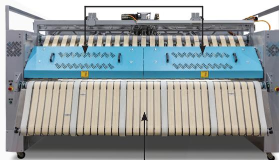
*Banda transportadora de salida mesa de descarga móvil hacia abajo*
