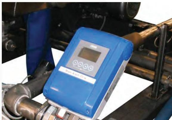
El sistema de flujo de lavado tiene tanto un sensor de flujo inductivo como una válvula de control para controlar el flujo de la zona de lavado.
