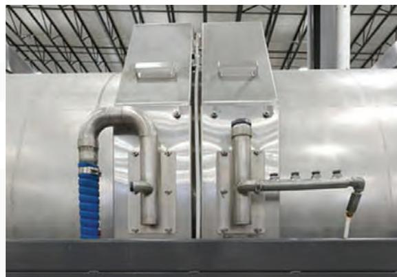
El agua y las sustancias químicas se inyectan en este lugar con las sustancias químicas agregadas por arriba del nivel del agua para permitir un mezclado apropiado y completo.
