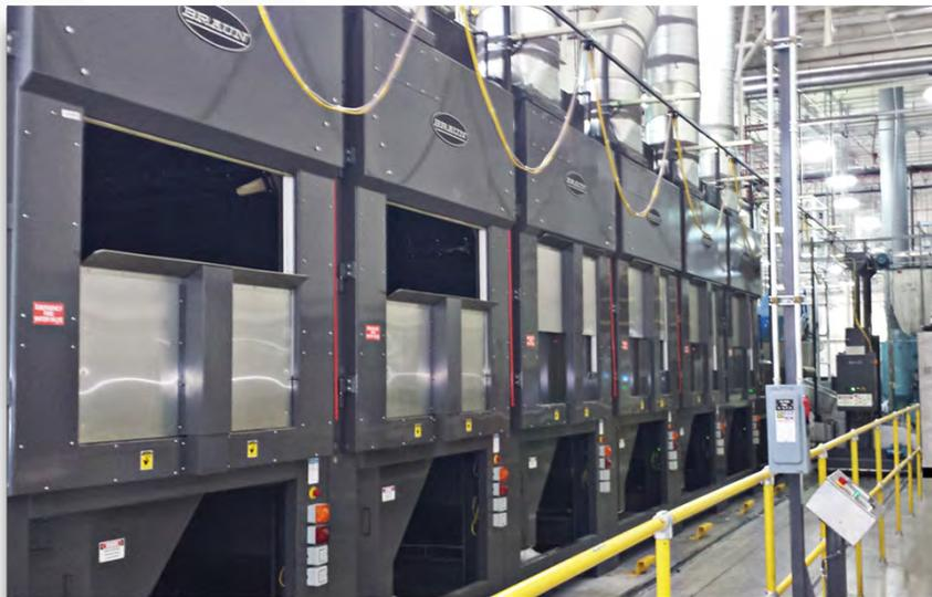
Se muestran las secadoras de carga sin conducto, laterales, Braun 300 PBS
